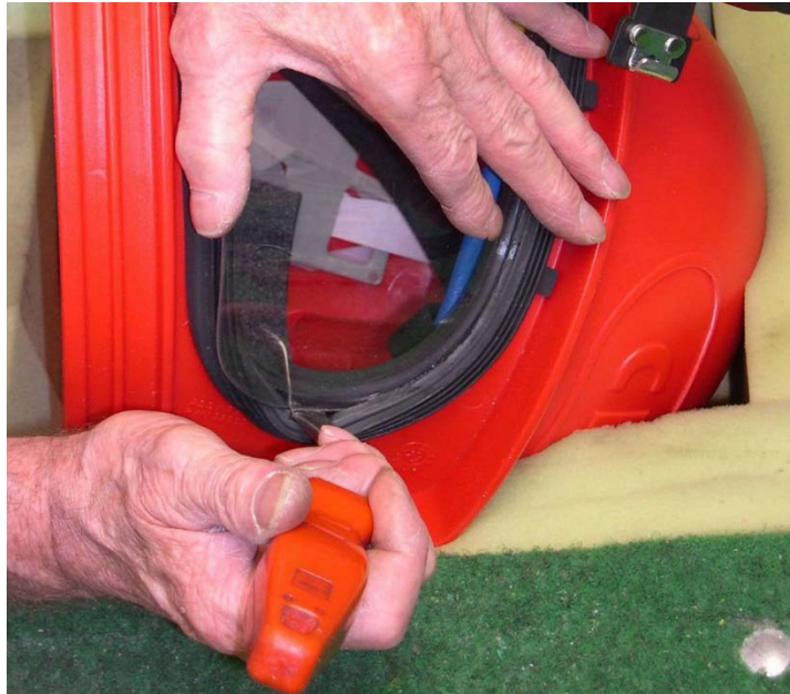
Bild 3: Montage Innenscheibe mit Hilfe des Montagewerkzeuges
